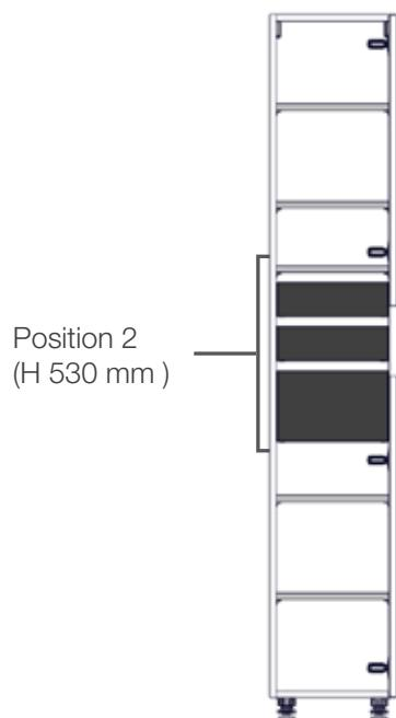
Dimensions intérieures des tiroirs, identiques dans les 2 hauteurs 95 mm et 196 mm. L = largeur de colonne commandée
