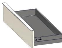
Tiroirs double parois métallique anthracite, sortie totale amortie avec tube rectangulaire. Découpe siphon métallique laquée anthracite intégrée dans le tiroir du haut. La découpe siphon du tiroir du haut est toujours centrée dans la largeur du sous-vasque. Profondeur utile : 331 mm, sauf sous-plan 2 tiroirs : 431 mm.
