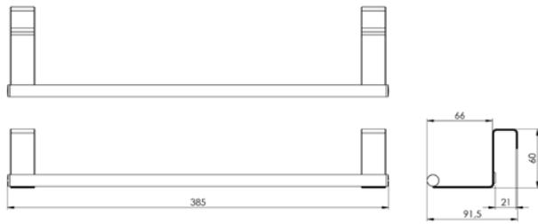
A fixer sur le côté du meuble. Perçage à effectuer sur chantier.
