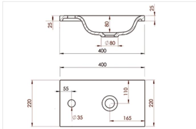
Plan vasque en matériau de synthèse blanc brillant, composé de polyester et de carbonate de calcium avec un revêtement en surface Gel Coat de type ISO. Sans trop plein, livré avec bonde de vidage à écoulement libre chromé. Profondeur de la vasque: 110 mm.
