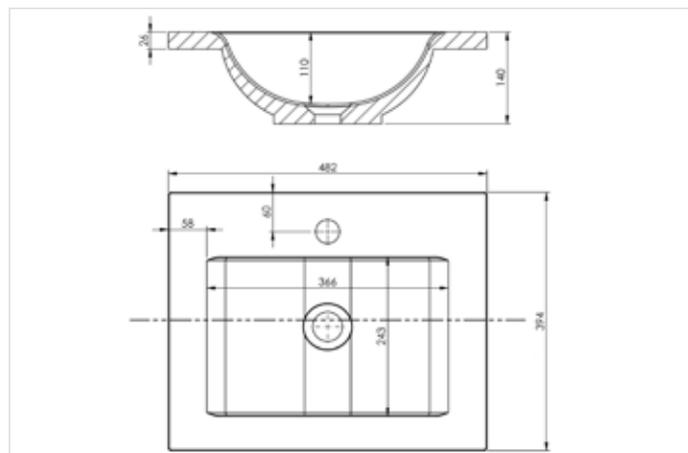
Plan vasque en matériau de synthèse blanc brillant, composé de polyester et de carbonate de calcium avec un revêtement en surface Gel Coat de type ISO. Avec trop plein, livré avec bonde de vidage à écoulement libre chromé. Profondeur de la vasque: 79 mm.
