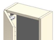
Meuble monté tourillonné collé, suspendu par boîtiers d'accrochage réglables anti-décrochement. Vide sanitaire : 90 mm.
