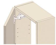
Meuble monté tourillonné collé, suspendu par boîtiers d'accrochage anti-décrochement réglables.
