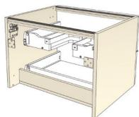
Meuble monté tourilloné collé, suspendu par boîtiers d'accrochage anti-décrochement réglables, avec possibilité de soutien par des pieds. Vide sanitaire 60 mm.
