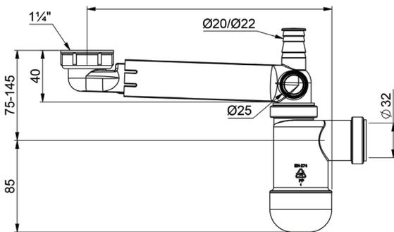
Siphon recoupable et extensible recommandé avec système Clou
